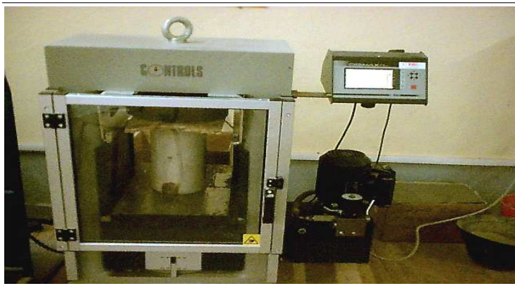
Figure 2 : Photo de l'essai d'écrasement à la presse
